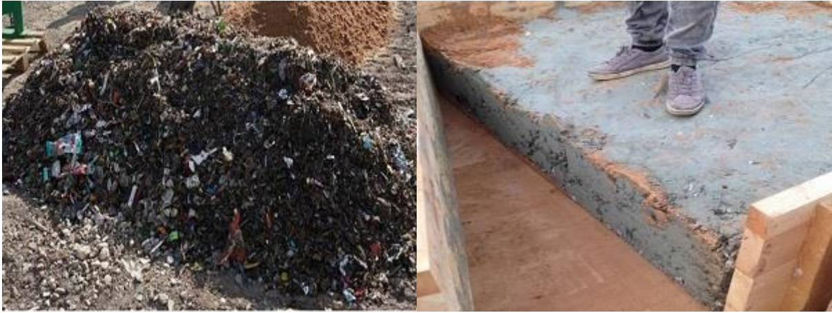
Рисунок 2. Внешний вид ОМО (слева) и геополимера ГУТ (справа).
