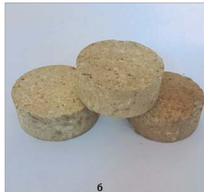
Образец ГУТ, изготовленный с применением золошлаковых отходов ТЭЦ (а) и отходов бурения (б)
